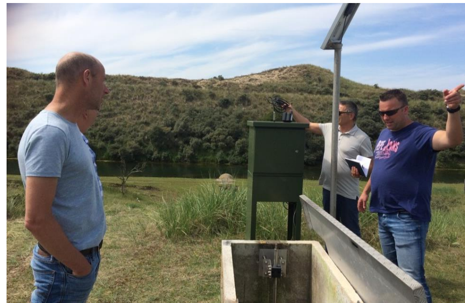
Testen van oppervlaktewater- en grondwatermetingen via LPWAN in de Amsterdamse Waterleidingduinen
