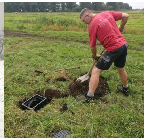
Grondwatersnelheid meten in de zomer
